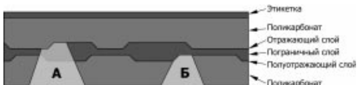
Рис. 15. Структура двухслойного диска DVD с лучами лазера, сфокусированными на верхнем (А) и нижнем (Б) слоях
