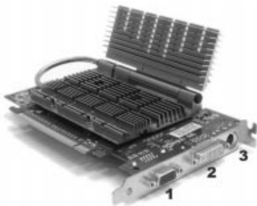
Рис. 18. Видеокарта PCI-E; разъемы: VGA (1), DVI (2), S-Video (3)
