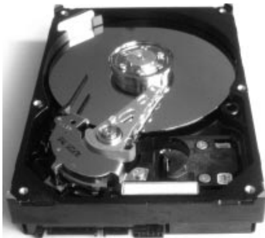
Рис. 12. Жесткий диск со снятой крышкой
